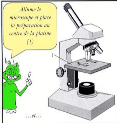
Allume le microscope et place la préparation au centre de la platine (1)
